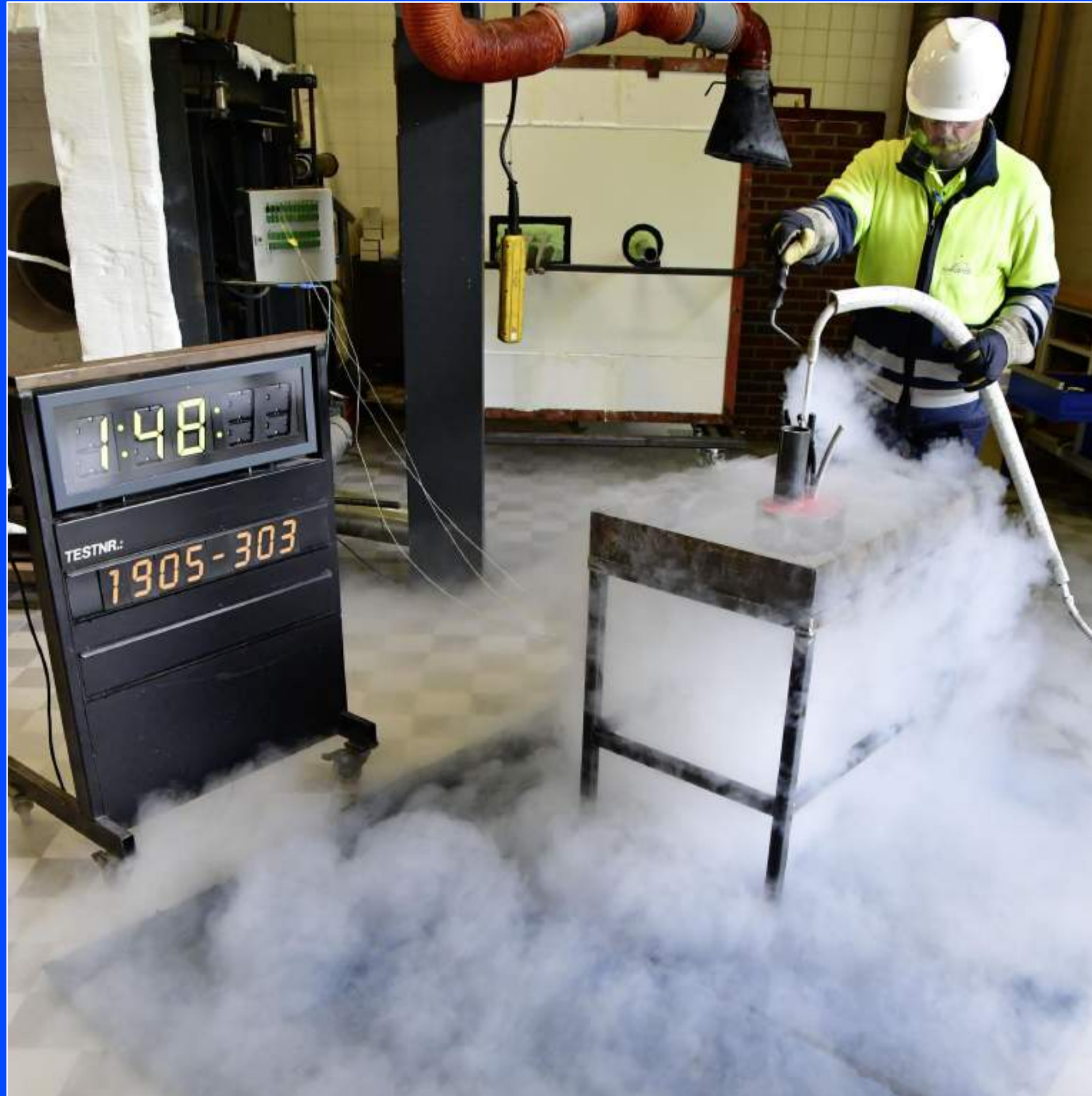
MULTI-KABELSCHOTT - Material Technologie für möglicher Ausstellung an LNG Leckagen Test mit flüssig Stickstoff - 196 °C
