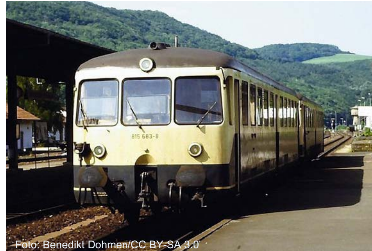
ETA 150/BR 515/815: Akkumulatorkapazität bis 603 kWh, Reichweite bis 400 km, v_{\max} = 100 km/h, ausgemustert 1995
