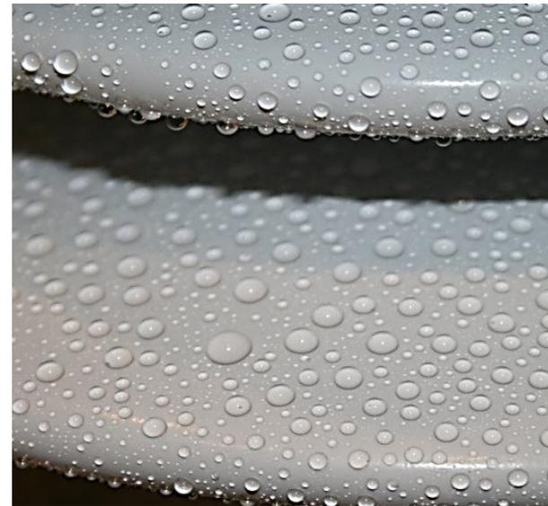
Bild: Porzellanisolator mit Coating benetzt, HS Zittau
