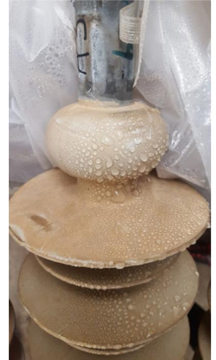
Bild: Verbundisolator mit Hydrophobietransfer in Verschmutzungsschicht, J. Görlich
