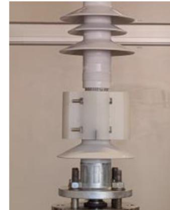
Bild: PP säureresistente Manschette, HS Zittau
