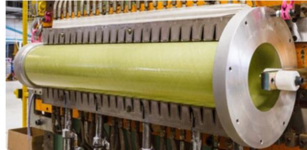
Bild: Silikon im Spritzgußverfahren aufbringen, Lappinsulators
