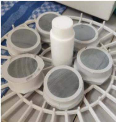
Bild: Strunkabschnitte Verbundisolator, HS Zittau
