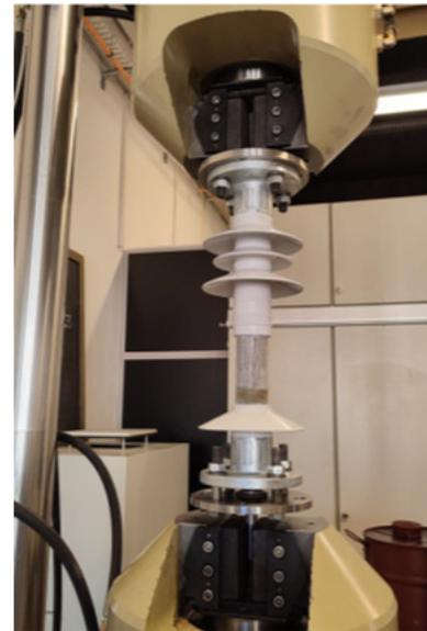
Bild: Verbundisolator unter Zugbelastung, HS Zittau
