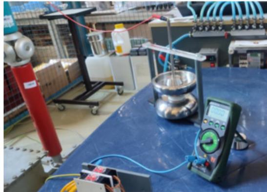
Bild: Strunkabschnitt zw. Hochspannungselektroden, HS Zittau
