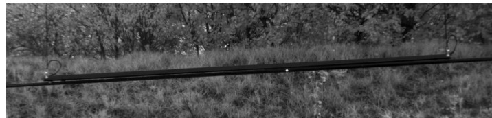
4.) Nachschwingen des ZG-Fahrdrathes mit Lichtbögen zwischen den Fahrdrähten (3 ms)
