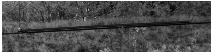
3.) Nachschwingen des ZG-Fahrdrathes mit Lichtbögen zwischen den Fahrdrähten (3 ms)
