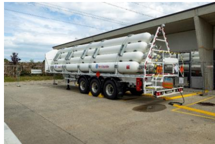
Trailer: Air Liquide (200bar mit ca. 300kg H 2 )
