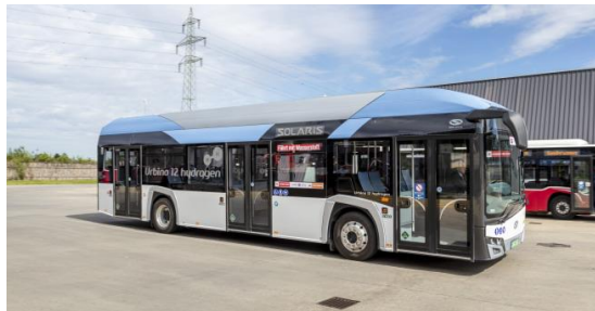
Fahrzeughersteller: Solaris mit Ballard-Brennstoffzelle (350bar)
