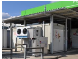
Hochdruckprüfstand bis zu 1000 bar mit Klimakammer
