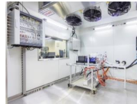
Brennstoffzellen- systemprüfstand 160 kW mit Klimakammer
