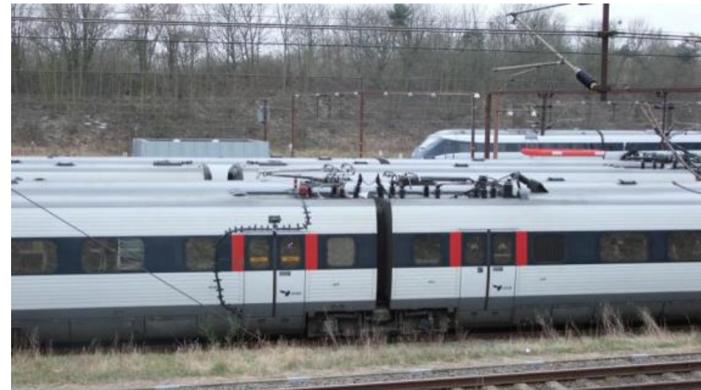
Messstromabnehmer: SSS400 auf Triebzug IR4 mit 76,5 m Abstand.
